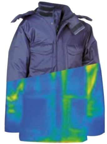
La colorazione tendente al blu dimostra la mancanza di vie di fuga di aria calda dal capo.
